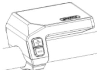
3. Nyní připojte konektor displeje ke konektoru sběrnice EB-Bus, přičemž dbejte na to, aby oba konektory zůstaly po pevném přitlačení k sobě paralelně.
