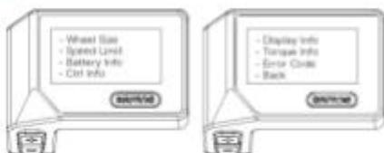
Stisknutím tlačítka **[F1]** nebo **[F2]** (<0,5S) zvýrazněte položku "Wheel Size" (Velikost kola) a poté stisknutím tlačítka **[F3]** (<0,5S) potvrďte a zobrazte velikost kola. Pro návrat stiskněte tlačítko **[F4]** (<0,5S), abyste se vrátili zpět na obrazovku "Informace".
