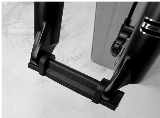
Obrázek 12 - Krytka uchycení osy kola
