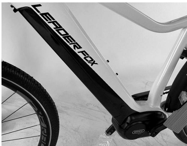
Obrázek 19 - Rám elektrokola s nainstalovaným motorem a baterií
