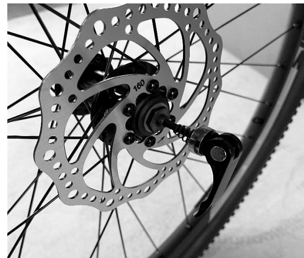
Obrázek 15 - Zasunutí rychloupínáku do osy kola
