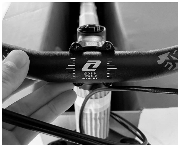
Obrázek 7 - Vycentrování řídítek v představci
