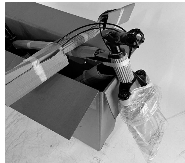
Obrázek 3 - Možnost použití krabice jako montážního stojanu
