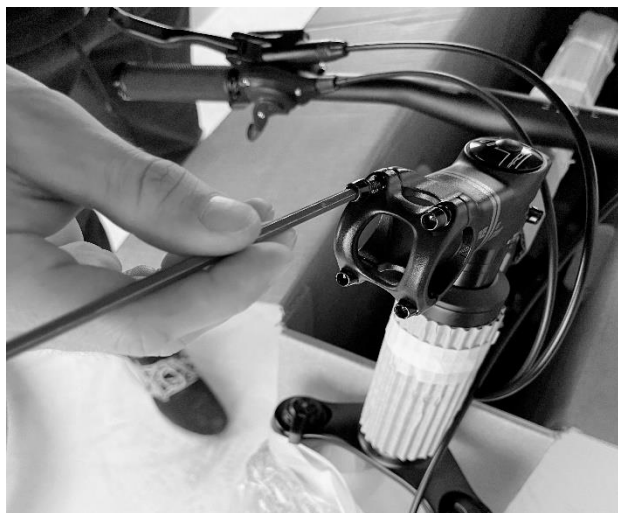
Obrázek 6 - Uvolnění šroubů představce
