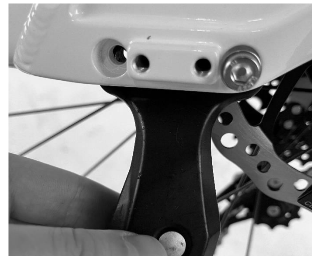
Obrázek 27 - Otvory pro šrouby pro uchycení stojanu
