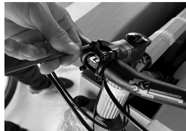
Obrázek 8 - Dotážení šroubů představce
