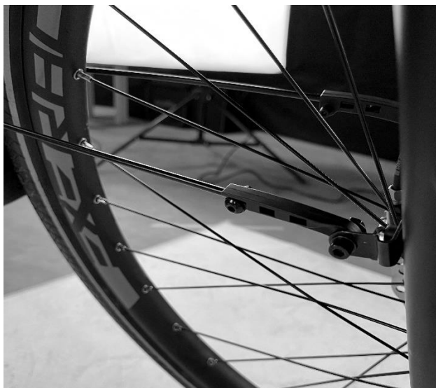
Obrázek 24 – Upevnění předního blatníku k nohám vidlice
