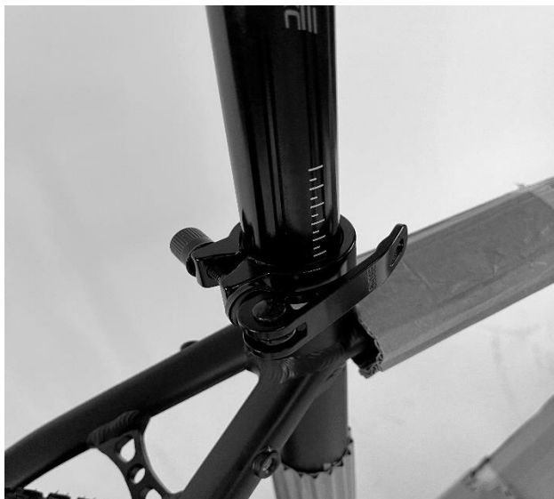
Obrázek 5 - Nastavení požadované výšky sedlového sloupku
