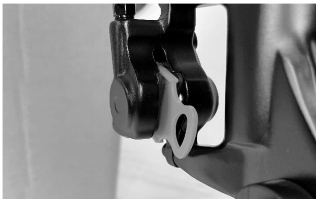
Obrázek 11 - Transportní zámek brzdy
