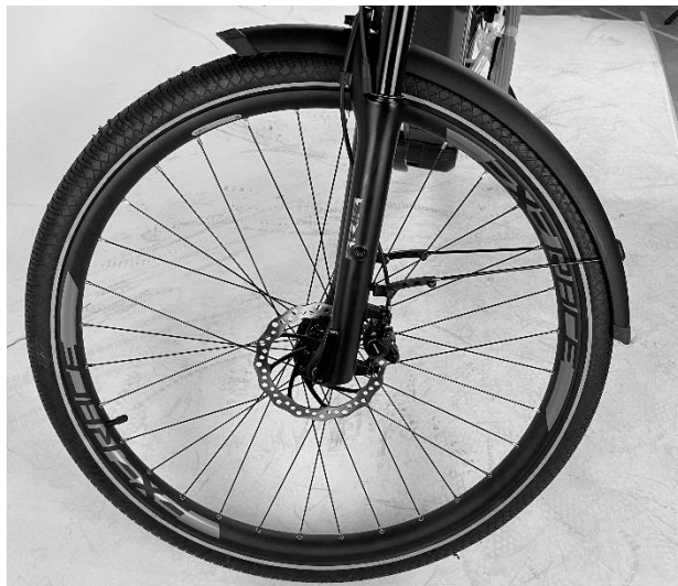
Obrázek 25 - Správně nainstalovaný přední blatník
