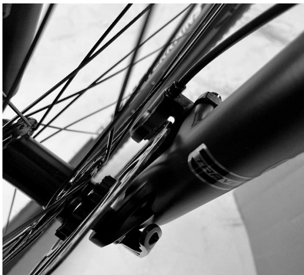
Obrázek 16 - Správná poloha brzdového kotouče
