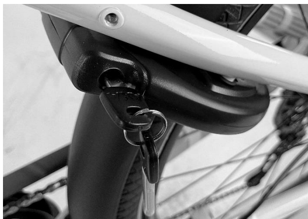
Obrázek 31 - Integrovaný zámek kola
