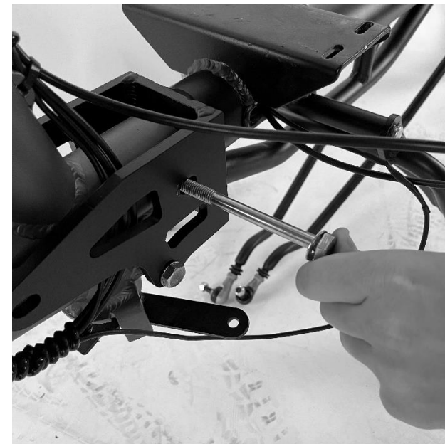
Obrázek 12 - Šroubové spoje zajišťující spojení rámu
