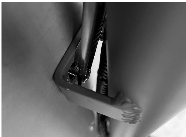
Obrázek 24 - Šroubové spoje cargo boxu - připevnění na hlavovou trubku
