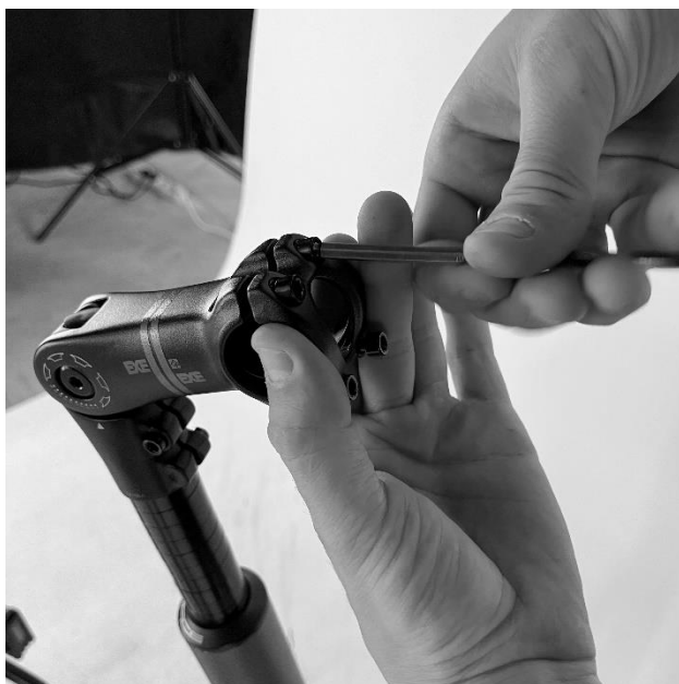
Obrázek 17 - Uvolnění šroubů představce
