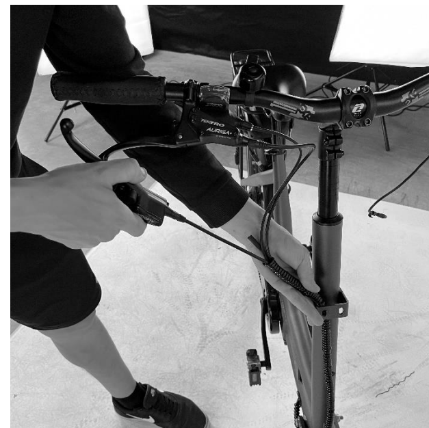
Obrázek 19 - Povytažení lanka přední brzdy
