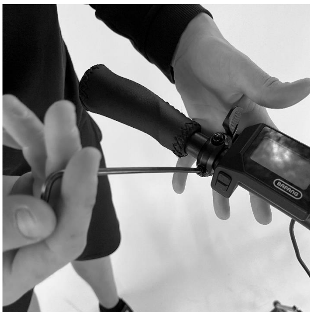
Obrázek 20 - Montáž páčky přední brzdy
