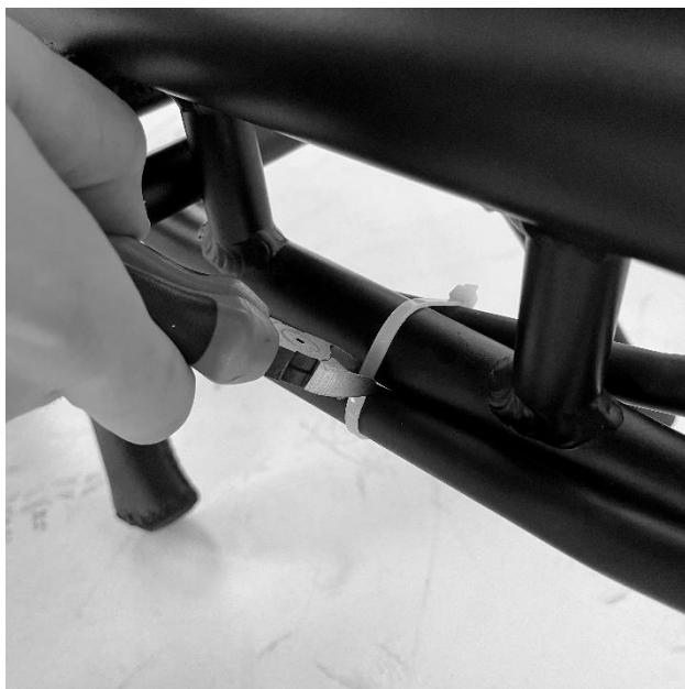
Obrázek 9 - Páska zajišťující táhla řízení
