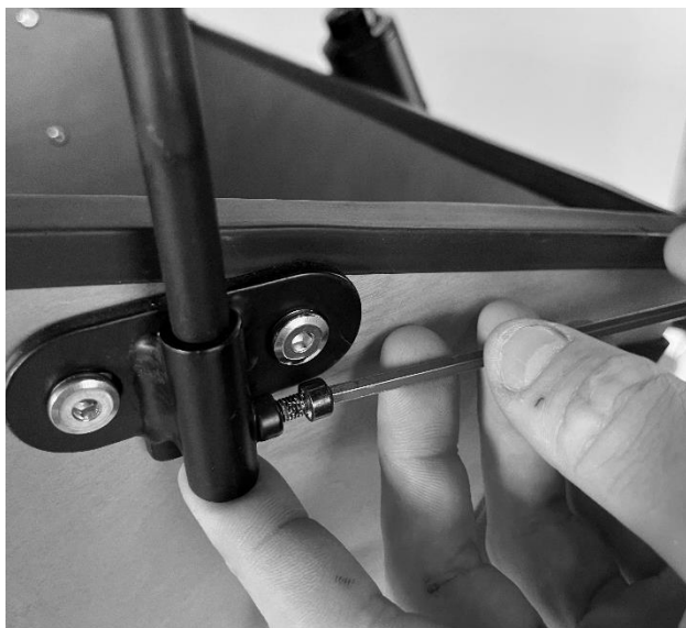
Obrázek 27 - Zajištění konstrukce plachty
