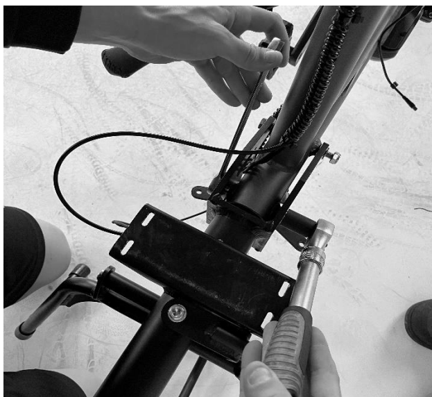
Obrázek 14 - Utažení šroubových spojů
