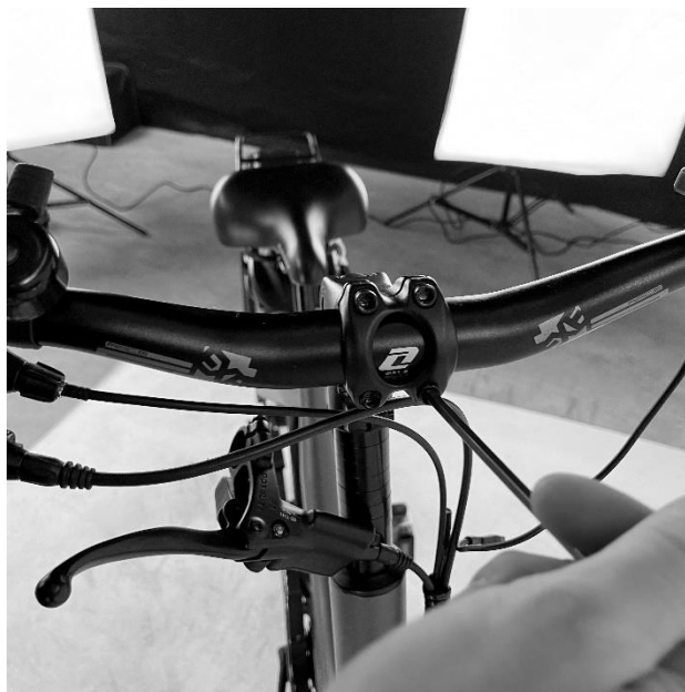
Obrázek 18 - Utažení šroubů představce
