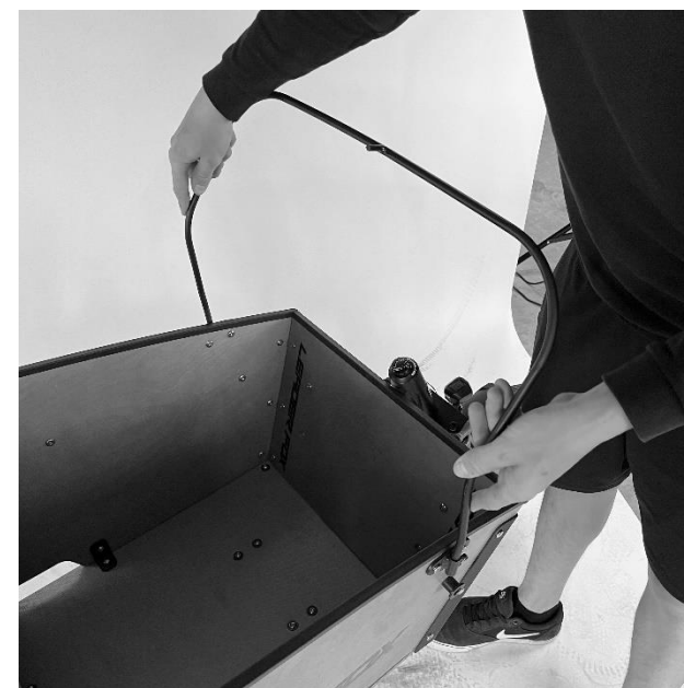
Obrázek 26 - Vertikální trubka konstrukce plachty
