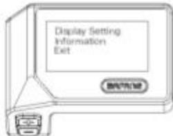
Stiskněte tlačítka **+** nebo **-** ( $<0,5S$ ) a zvýrazněte položku Display Setting (Nastavení displeje) a poté krátce stiskněte tlačítka **+** ( $<0,5S$ ) pro přístup k následujícím volbám.
