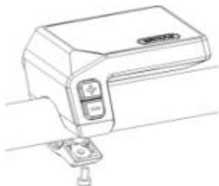
2. Poté umístěte držák na spodní stranu displeje a utáhněte jej pomocí šroubu M3,0\*8. Požadovaný točivý moment: Hodnota točivého momentu: 1 N.m.
