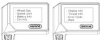
Stisknutím tlačítka nebo (<0,5S) zvýrazněte položku "Wheel Size" (Velikost kola) a poté stisknutím tlačítka (<0,5S) potvrďte a zobrazte velikost kola. Pro návrat stiskněte tlačítka (<0,5S), abyste se vrátili zpět na obrazovku "Informace".
