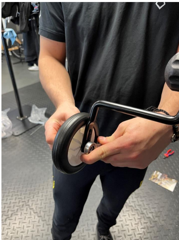
Obrázek 14 - Zajištění matice přidavného kolečka
