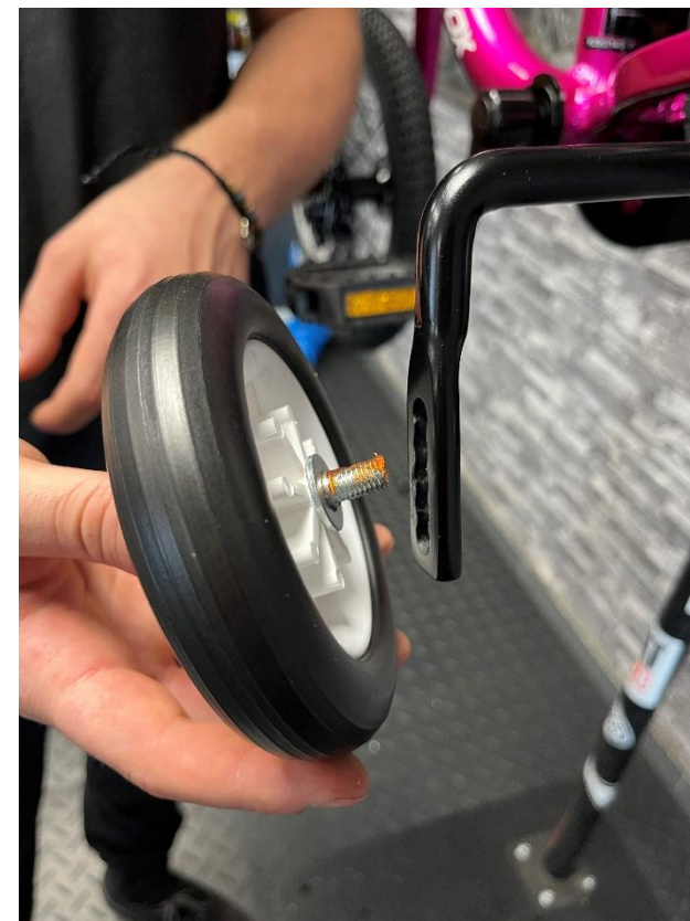
Obrázek 13 - šroub pro upevnění kolečka ke konstrukci
