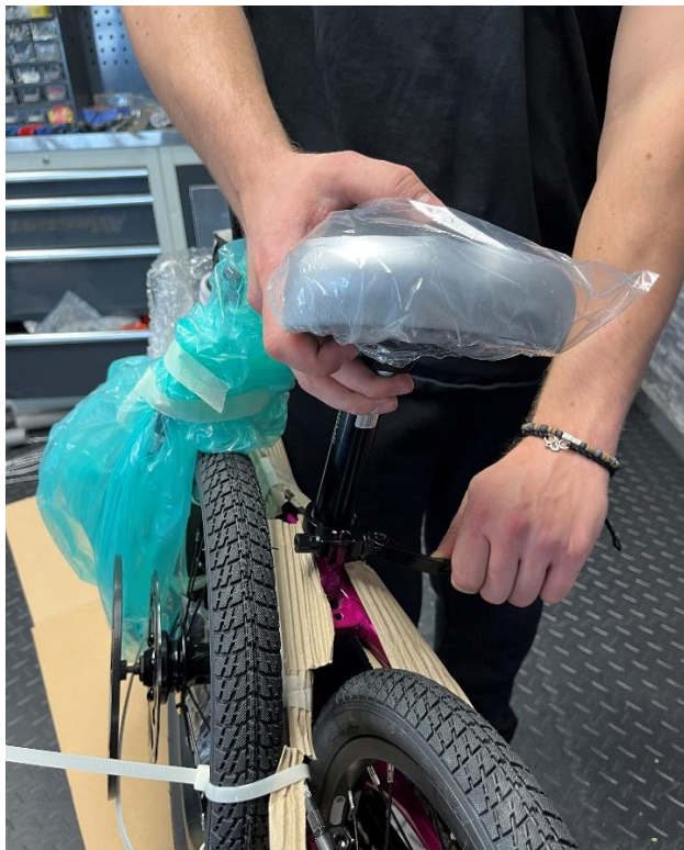
Obrázek 5 – Vložení sedlového sloupku do sedlové trubky
