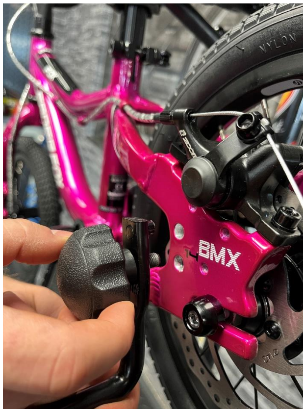
Obrázek 17 - Montáž konstrukce přidavných koleček
