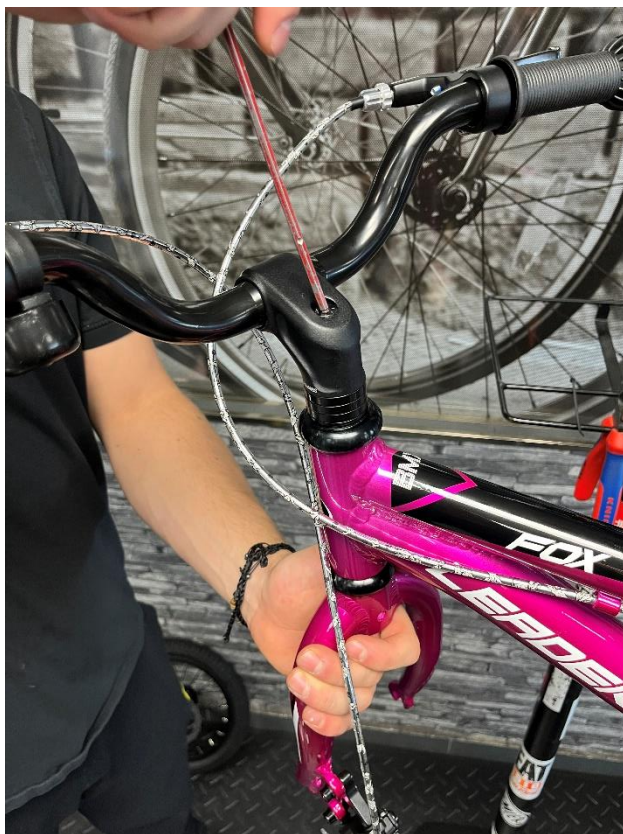
Obrázek 11 - Montáž řídítek s představcem
