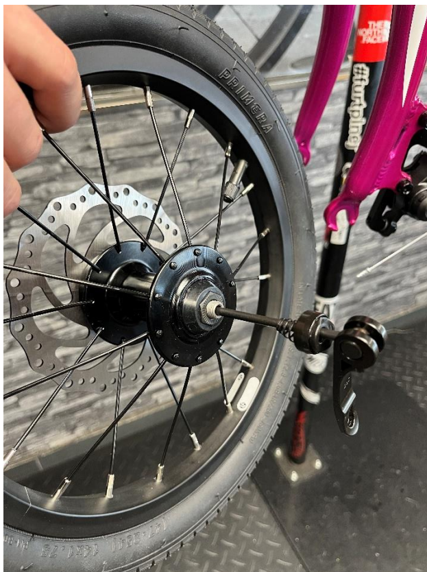
Obrázek 14 - Rychloupínací osa nasunutá v náboji předního kola
